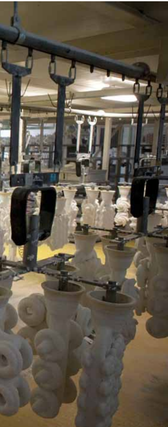
Der konventionelle Trocknungsprozess von Gießtrauben, wie hier in einer ungarischen Feingießerei, dauert rund 24 Stunden. Die Trocknungstechnologie von MK Technology, Grafenschaft, senkt die Trocknungszeit auf 30 Minuten.
